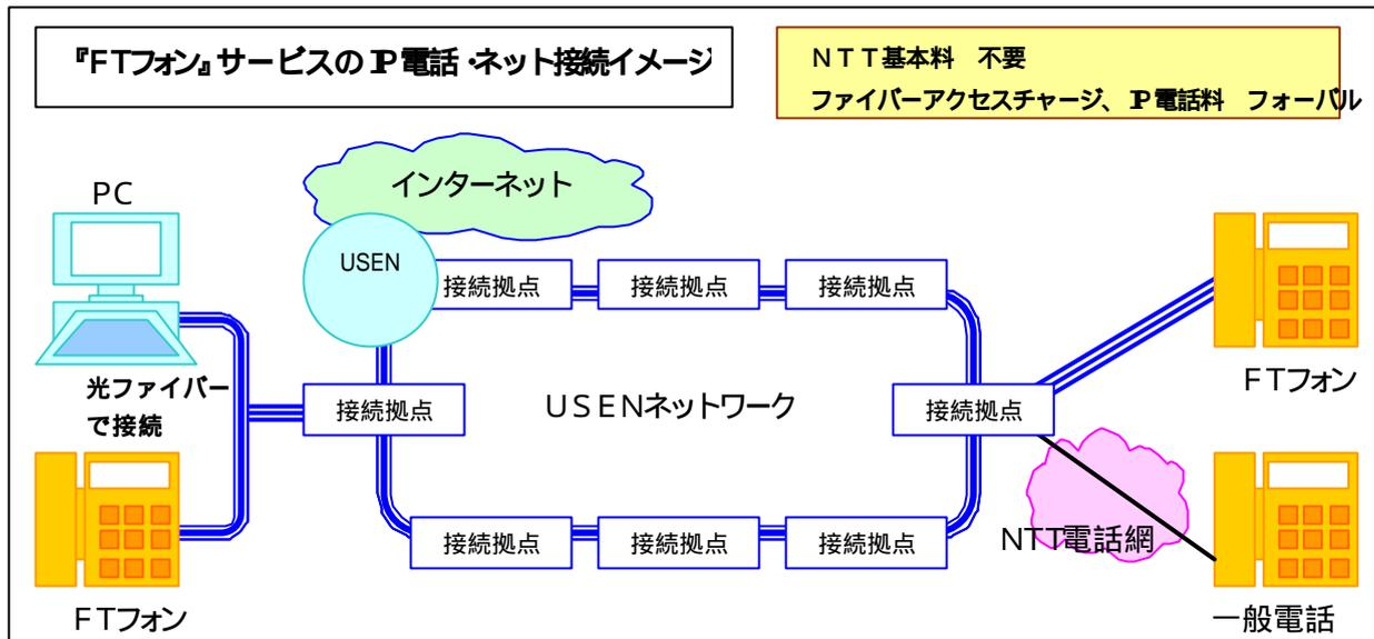
『FTフォン』サービスのP電話・ネット接続はADSLを利用したものと基本的な接続形態は同じですが、アクセス回線に光ファイバーを使用しているため、下記の優位点を持っています。
